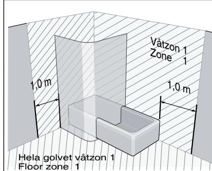
**Skruvinfästningar i våtzon 1 ska göras i massiv konstruktion såsom betong, reglar, särskild konstruktionsdetalj eller i Våtrumsvägg 2012.**
